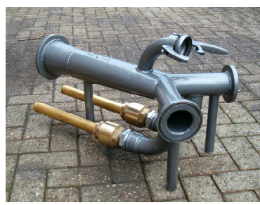
Verlopend verdeelstuk: 5" naar 2x 3" en 1x 2". met 2 Vacuum-onderbrekers en geluiddempers
